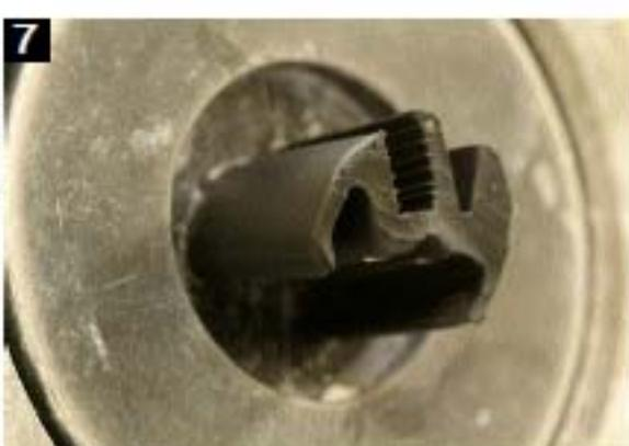
Der Extruder funktioniert im Prinzip wie ein Fleischwolf. Er wird mit warmem Rohgummi gefüttert, das er durch das Mundstück in Form presst. Es braucht erfahrene Hände, damit sich das frische Profil nicht verdrillt. Talkum verhindert das Verkleben des noch unvulkanisierten Materials.
