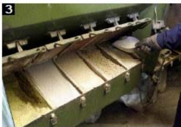
**3** Rund 100 verschiedene Zutaten kennen die zahlreichen Gummirezepte. Für eine Mischung werden etwa 20 unterschiedliche Reagenzien in exakt definierter Menge benötigt. Während früher Mischungen aus Erfahrung entstanden, wird heute auf ein Gramm genau gewogen.
