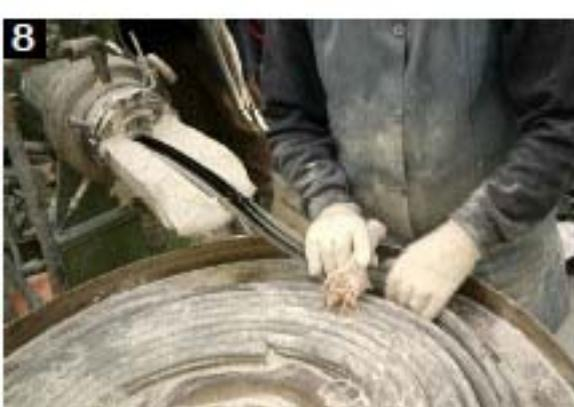
Aus dem Endlosprofil entstehen anschließend konfektionierbare Rahmen. Sie werden auf Länge geschnitten und mit einem speziellen, mitunter eigens gemixten Klebstoff zusammengesetzt. Das Längenmaß wurde vorab mit einem ersten Exemplar an der Scheibe überprüft.
