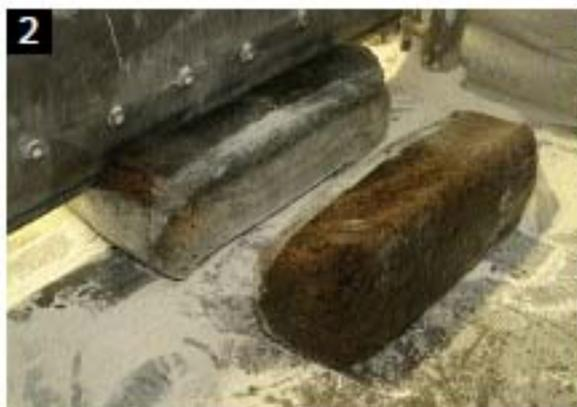
**2** Wichtigste Grundkomponente eines Gummis ist Kautschuk. Früher kam ausschließlich pflanzlicher Kautschuk zum Einsatz. Bei technischen Anwendungen haben jedoch längst synthetisch erzeugte Kautschuksorten das weder öl- noch ozonbeständige Naturmaterial ersetzt.
