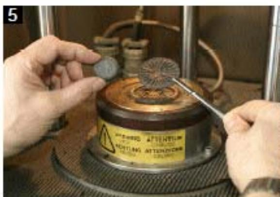
**5** Rheometer heißt dieses Laborgerät, das die Fließeigenschaften der Gummimischung prüft. Ein ausgestanztes Stück Rohgummi (links) wird unter Druck und Reibung vulkanisiert. Vor Beginn der Produktion werden zudem wichtige Kriterien wie Ozonresistenz oder Härte untersucht.
