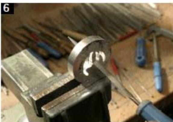
Rohgummi quillt beim Extrudieren um bis zu 20 Prozent. Jede Mischung verhält sich dabei anders, auch die Form nimmt Einfluss auf das Ergebnis. Deswegen darf der Profilquerschnitt nicht deckungsgleich, sondern muss modifiziert auf das Mundstück übertragen werden.
